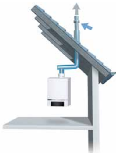
Varianta de montare cu admisie separată a aerului, cu folosirea conductelor concentrice.
