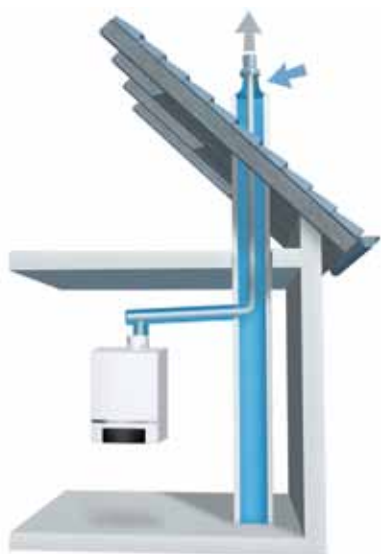
Varianta de montare cu admisie separată a aerului, cu tubatură de plastic trasă prin coșul de fum (indicată în cazul aerisirii cu ventilator)
